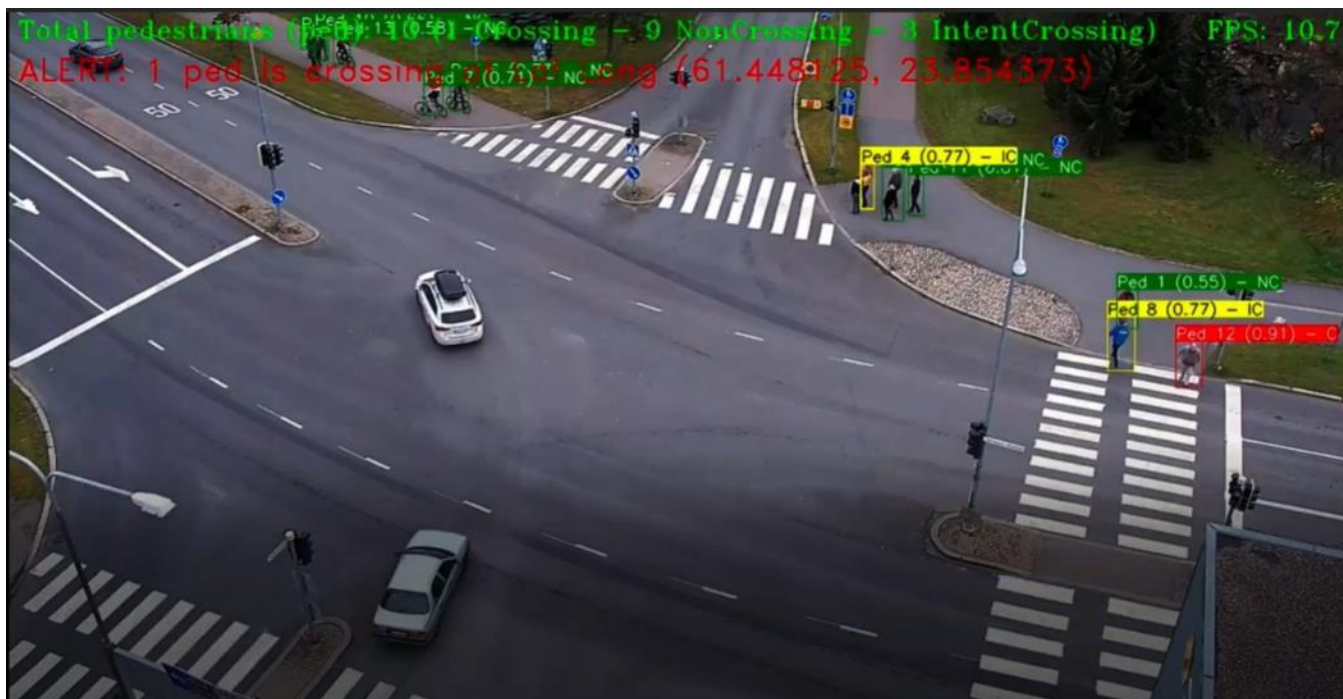
Obrázek 21 - Ilustrace fungování systému detekce chodců
