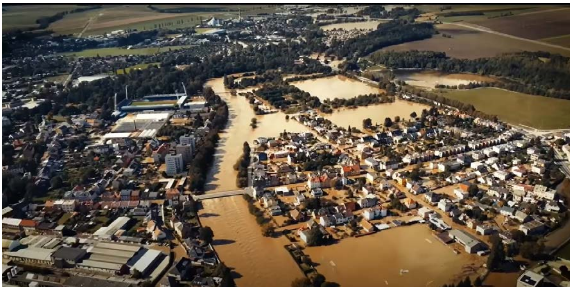
Obr. 5.3 PPO Opava na Opavě, přeléváná levobřežní hráz během povodně.
