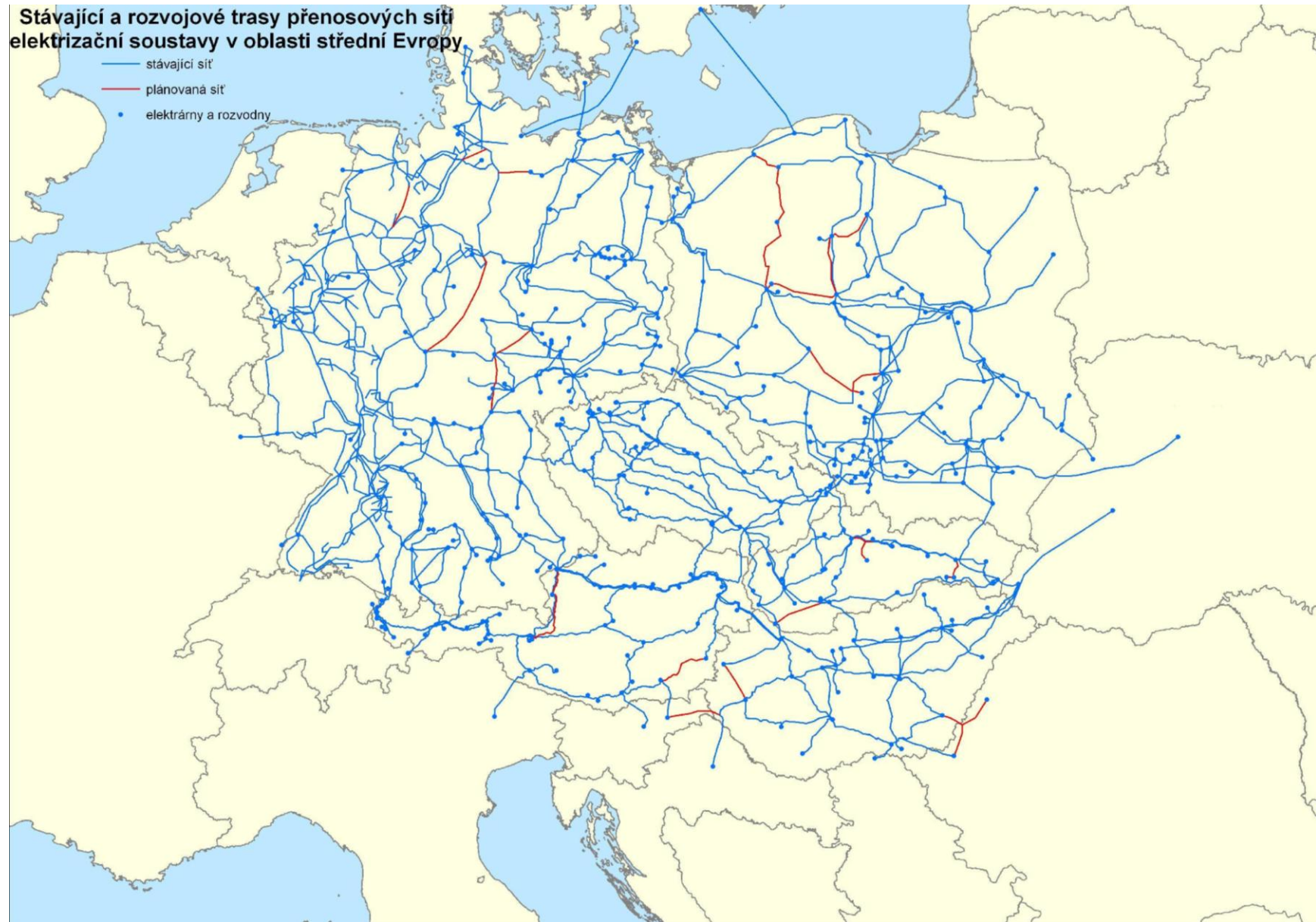
Schéma 11 Elektroenergetika (vedení 400 kV a 220 kV) – evropské souvislosti (z dokumentu „Širší vztahy“)
